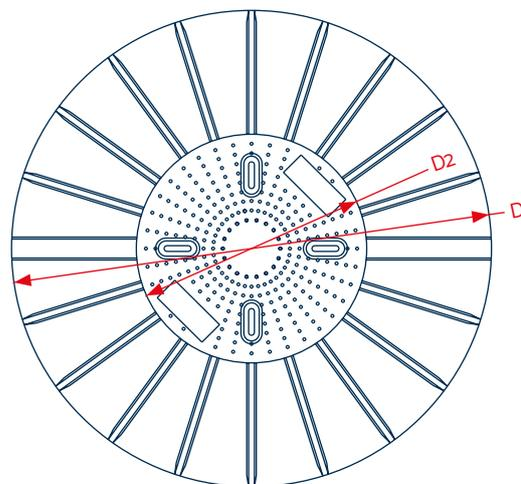
Fugenteiler solo für Terrassenlager unterlegbar
